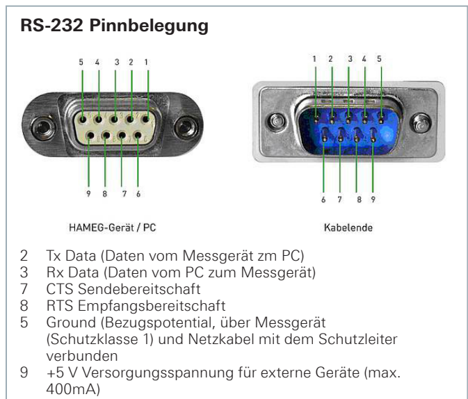
Abb. 12.1: Pinbelegung RS-232
